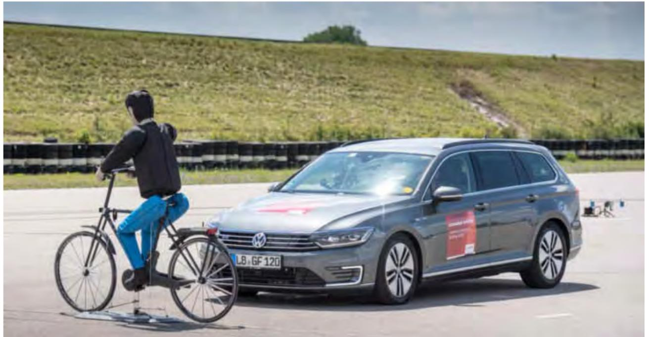
Im Fall der Fälle bremsst das Auto schneller als der Mensch reagieren könnte: Automatische Notbremssysteme befinden sich weiter auf dem Vormarsch. Foto: djdBosch
